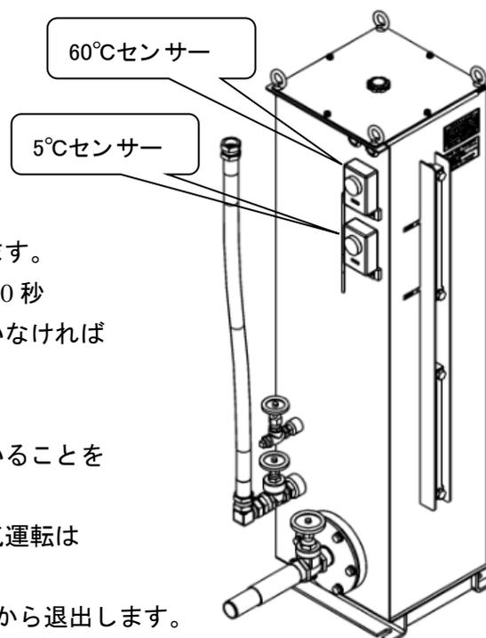
作動液温度抑制装置
