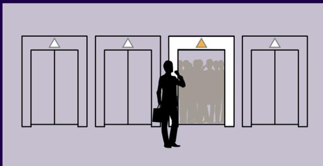
利用者の行先階が集約されないため、混雑時には停止回数が多く、定格速度での運行ができません。
