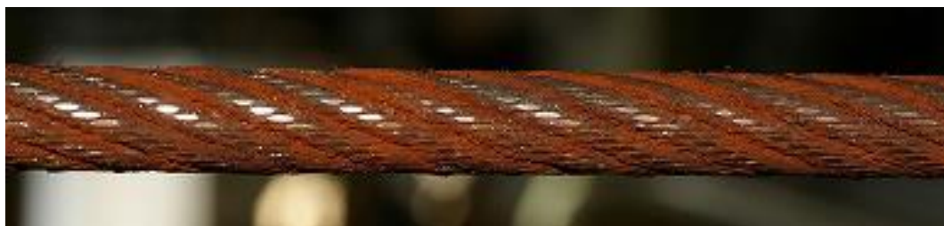
錆びた摩耗粉により谷部が赤錆色に見えるロープ
