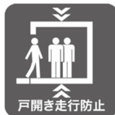
戸開走行保護装置
